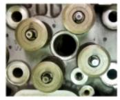
LB7 INJECTOR BORE - NO THREADED **BOSS TOWARD INTAKE PORTS**
